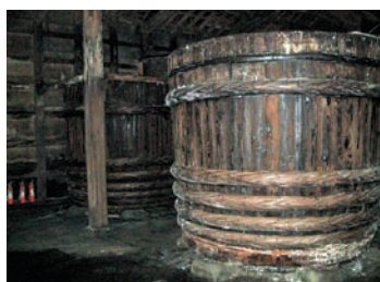
醸造用の杉の大樽がならぶ、 昔ながらの蔵の様子 (入正醤油：東庄町)
